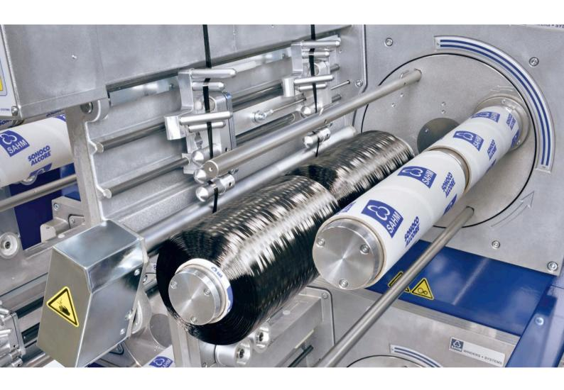
Die automatische Präzisions-Kreuzspulmaschine **CarbonStar 2-cop** ermöglicht die effiziente Produktion von zwei Spulen (je bis zu 20 kg) auf einem Spulkopf. Neben minimalem Platzbedarf und Wartungsaufwand zeichnet sie sich durch exakte Lauflängen und Spulenwechsel ohne Abfall und Stillstandszeiten aus.
