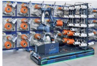
Der **SAHM CB1** automatisiert das nachgelagerte Spulenhandling in einer Form, die zuvor ausschließlich manuell möglich war und setzt damit neue Maßstäbe in der Prozessgestaltung.
