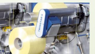
Dank neuer Technologien wie der Linearchangierung sind unsere Maschinen nahezu wartungsfrei. Auf den Einsatz rohölbasierter Hilfsstoffe wie Fett- und Schmiermittel kann nahezu vollständig verzichtet werden. Ein weiterer Schritt in Richtung Nachhaltigkeit und Ressourcenschonung.
